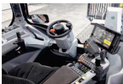
Stanowisko operatora z systemem FAO FAR CAN ELS wyposażonym w minijoysticki zabudowane w podłokietnikach ciągnika
