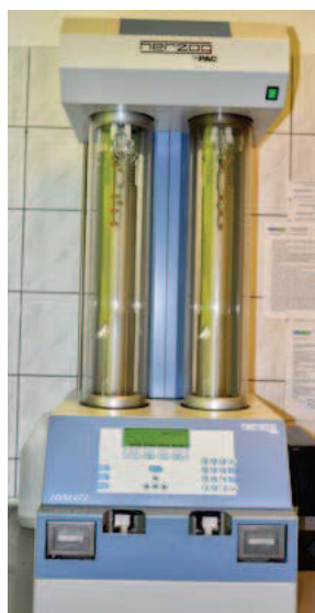
Lepkościomierz automatyczny – jakość olejów Ekomax sprawdzana jest na każdym etapie produkcji
